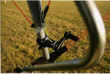
> Le winch possède un tambour conique pour linéariser son effet sur la tension de la voile.
