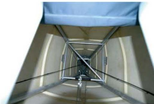
>> Vue interne du cône arrière en composite. Des omégas assurent la rigidité des flancs associés à une légère courbure. La structure travaillante n'a pas changé.
