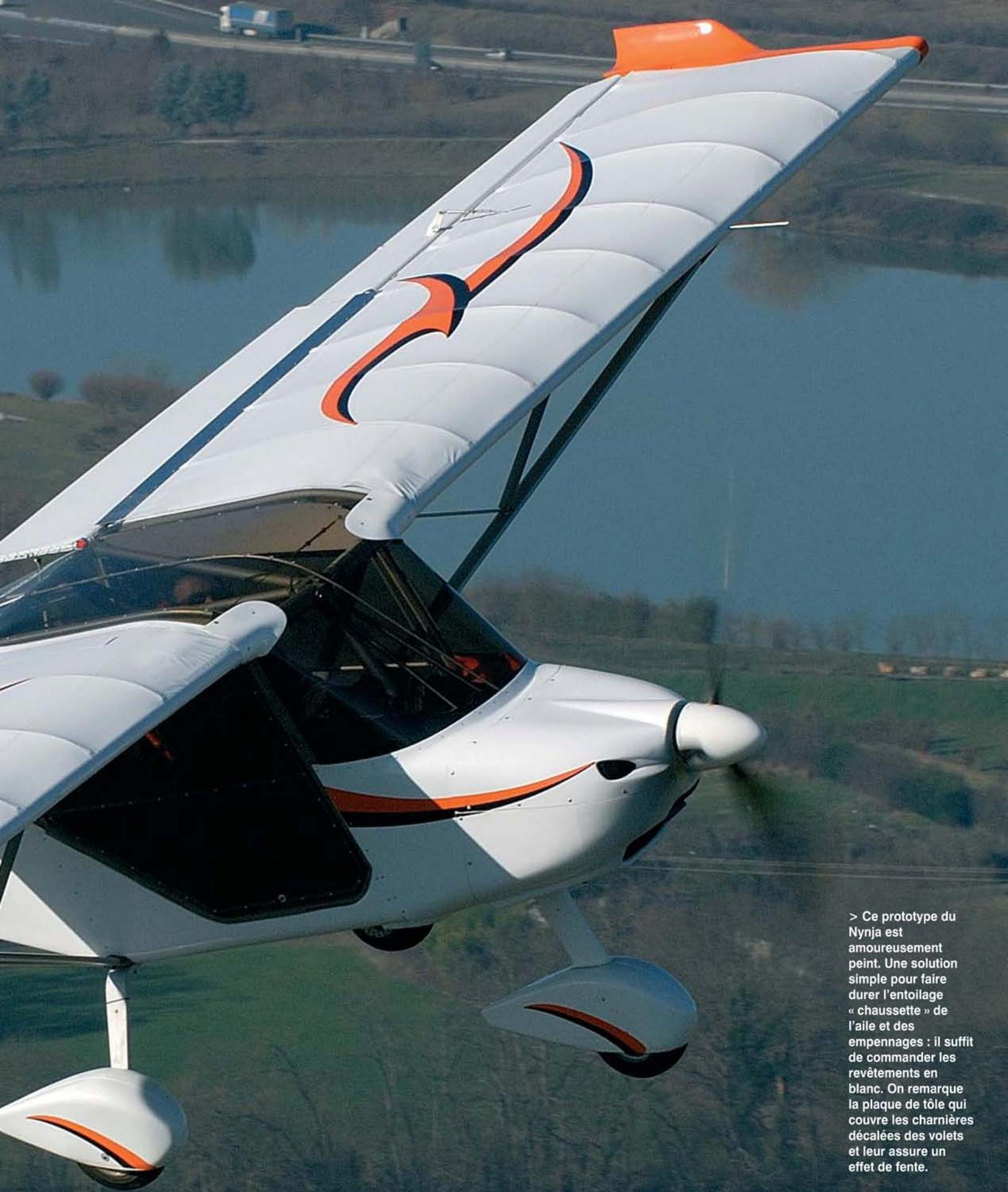
> Ce prototype du Nynja est amoureuxment peint. Une solution simple pour faire durer l'entoilage « chaussette » de l'aile et des empennages : il suffit de commander les revêtements en blanc. On remarque la plaque de tôle qui couvre les charnières décalées des volets et leur assure un effet de fente.
