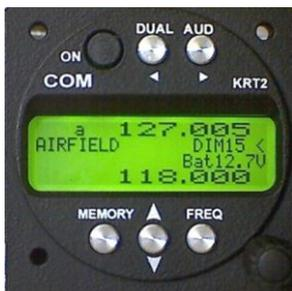
Au maximum de luminosité, l'écran consomme seulement 10mA. La luminosité maximum n'éblouit pas même dans l'obscurité et peut être utilisée en permanence.
